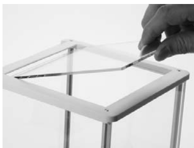
3) Install Top Door
